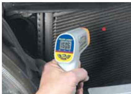
VB69228 Termometer IR med pistolgrep
