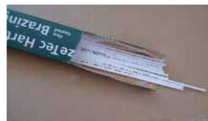
45% sølv med flux, hardlodd, kobber til messing, messing til stål
