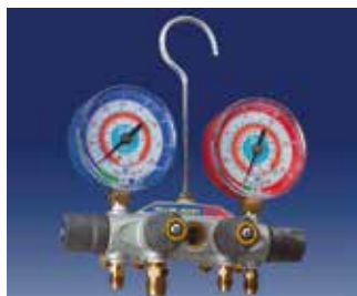
VB49936 og VB49969 Servicemanometer 4-veis. Titan for R410A, R404A og R407C.
